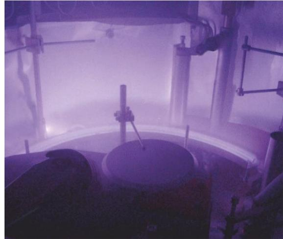
**Abbildung 7:** Glimmentladung in einer Beschichtungskammer. Der lange helle Bogen in unterer Hälfte ist der Glimmstab. Mit freundlicher Erlaubnis von Fa.Marquis.
