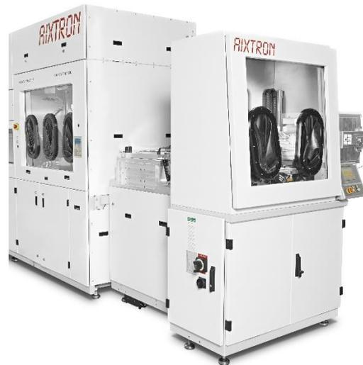
**Abbildung 5:** Eine Sektion einer Anlage für metallorganische chemische Gasphasenabscheidung (MOCVD). Der Handschuhkasten links schützt die Reaktorkammer vor Luft beim Service, über den Handschuhkasten rechts werden die Substrate ein- und ausgeschleust. Mit Erlaubnis von Fa. AIXTRON SE.
