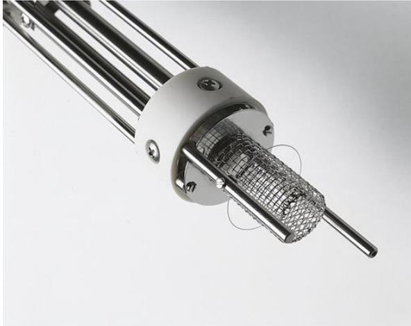
**Abbildung 11:** Analysator-Kopf eines RGA's. Seine Hauptkomponenten sind eine Ionenquelle, ein Massenfilter und ein Detektor von Ionenstrom (nicht gezeigt). Ionenquelle ist auf der weißen Keramik aufgebaut. Hinter der Keramik sind vier Stäbe des Massenfilters zu sehen, zwischen zwei Haltestäben. Bild: Fa. SRS Stanford Research Systems.
